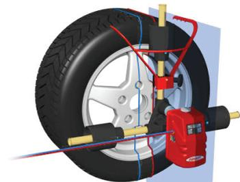
Se il sistema di misura non è centrato alla ruota, il sensore è comunque parallelo alla vettura: le misure rilevate sono corrette in quanto **I SENSORI FASEP MISURANO SOLO LUNGO LA VETTURA! (COME I SISTEMI 3D)**
